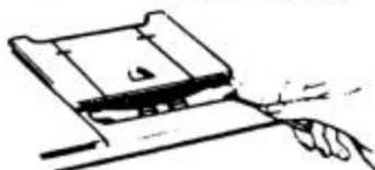
Til de klemveer in de groeven van de schuifplaat
